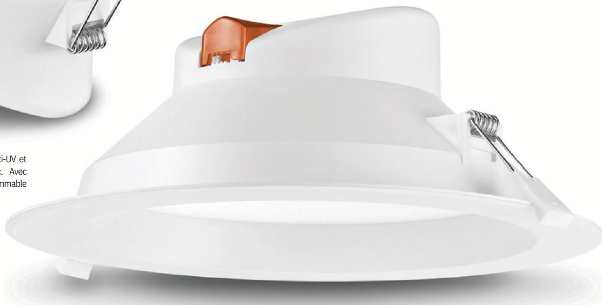
Boîtier thermo-conducteur plastique anti-UV et résistant à la chaleur, finition blanc. Avec diffuseur polycarbonate, driver non dimmable intégré. Eclairage 90°.
